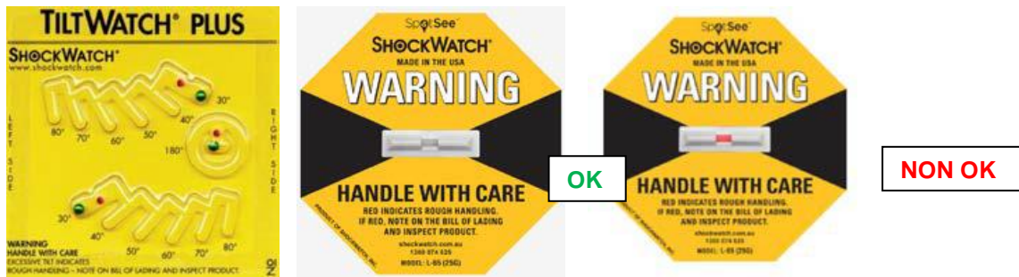
Figura 5: Indicatore di capovolgimento (TiltWatch Plus) e indicatore d'urto (ShockWatch)
