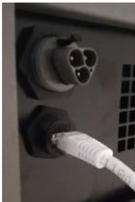
Figura 36: Connettori Ethernet, lato posteriore dell'unità
